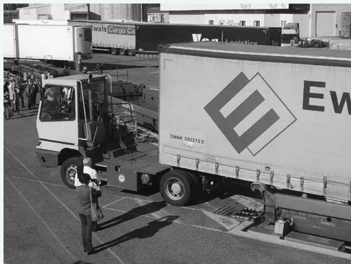
Technologie Modalhor - wagon à plancher pivotant permettant le transport de toutes les semi-remorques standards
